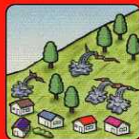
斜面から水がふき 出す
