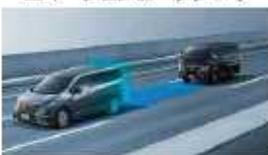
より速くまで検知でき、天候や周囲の明るさにも影響されにくいミリ波レーダーを搭載。フロントカメラとの相乗効果により、歩行者も検知可能に、ぶつかる可能性が高まると表示とブザーで回避操作を促し、安全に減速できなかった場合ブレーキが作動します。
