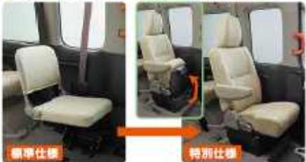
標準仕様では補助席の3列席を、「24時間テレビ特別仕様」では1人掛けリクライニングシートに変更しました。(シートベルトは3点式が装着されます。座面はチップアップ機構付きです)
